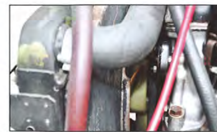
Még a vízpumpa tengelyéről kapja a hajtást a ventilátorlapát
