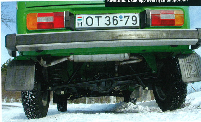
Klasszikus, a 2101-ből ismerős hátsó hidat és Panhard-rudat látunk, ha lapos kocsival Nivát követünk. Csak épp nem ilyen állapotban
